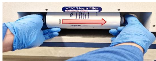
Abbildung 12.2 Verfahren zum Einsetzen und Entfernen des LCKW/HEPA-Filters
