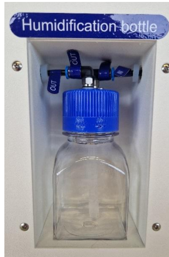
Abbildung 22.1 Schlauchanschluss an der Befeuchtungsflasche und am Mini MIRI® Humidity Mehrraum-IVF-Inkubator
